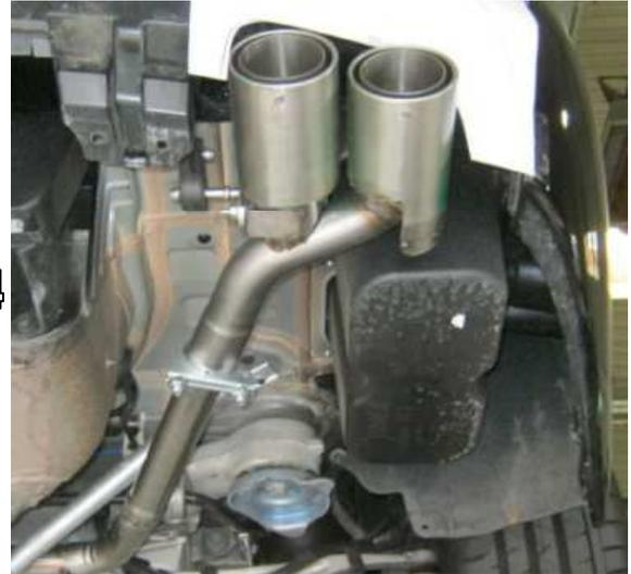
Klemm- oder Schraubverbindungen locker vorziehen. Den REMUS Sportschalldämpfer ausrichten und die Verbindungen fest anziehen. Motor kurz anlassen und den kompletten REMUS Sportschalldämpfer auf Dichtheit überprüfen. Sämtliche Bauteile, sowohl im kalten als auch im betriebswarmen Zustand auf Funktion und genügend Freigängigkeit überprüfen. Achten Sie dabei auf einen ausreichend belüfteten Montageaum.
